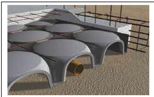
Viene eseguito un vespaio areato sotto tutta l'abitazione, con solaio costituito da travetti prefabbricati in laterizio (Appartamenti 1/2) e calcestruzzo precompresso (Appartamenti 3/4/5/6); blocchi di laterizio e sovrastante soletta collaborante di calcestruzzo di cemento R325 a dosatura q.li 3.00 dello spessore di cm 4 e resistente ad un sovraccarico totale (escluso il peso proprio) di 400 kg/mq, compreso il ferro d'armatura o con iglù.
